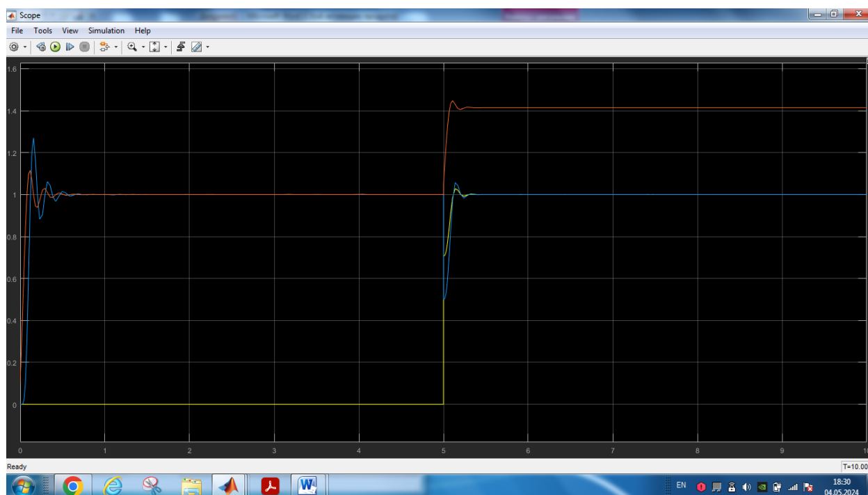
Şəkil 2. Nasosun avtomatlaşdırılmış elektrik intiqalının idarəetmə sisteminin riyazi modeli və oscillogramının göstərişi
